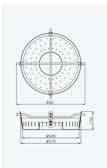
**Artikel: Ringschmutzfänger, Sonderausführung für Schachtabdeckung LW600**
