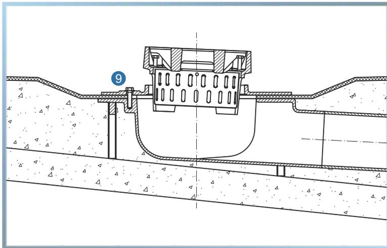
**4** Nach dem Justieren den Klemmring bei Bedarf fest anziehen und noch mal alle Schrauben **9** am Pressdichtungsflansch überprüfen.
