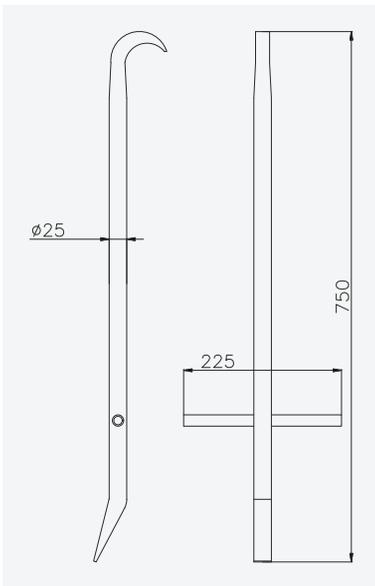
**Artikel:** Aushebehaken zum Öffnen von Deckeln
